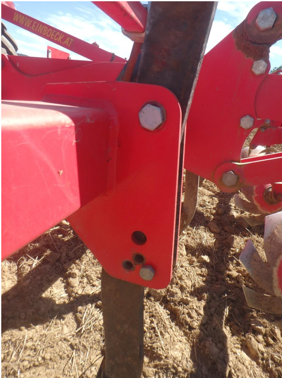
Höhersetzung jedes zweiten Grubberstiels, Scherbolzen hinter dem Stiel
