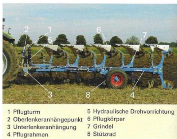
Abbildung 3: Aufbau eines Anbau-Drehpfluges (Meiners/ Dietsche/ et al, 2015, S. 378.)
