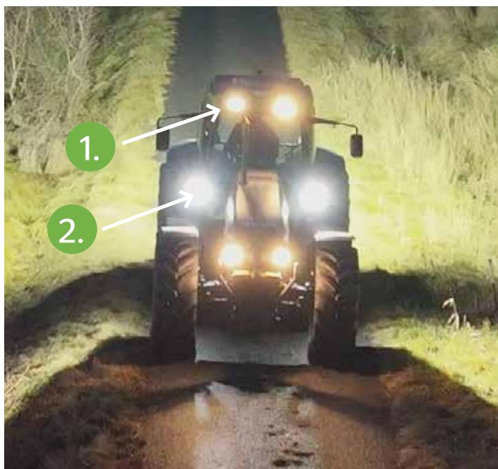
Die unterschiedliche Lichtfarbe der Scheinwerfer ist deutlich zu erkennen: Pfeil 1 zeigt auf einen Scheinwerfer mit H7 Lampe ohne LED Technik, Pfeil 2 auf den LED-Scheinwerfer mit deutlich hellerem Licht und tageslichtähnlicher Ausleuchtung.
